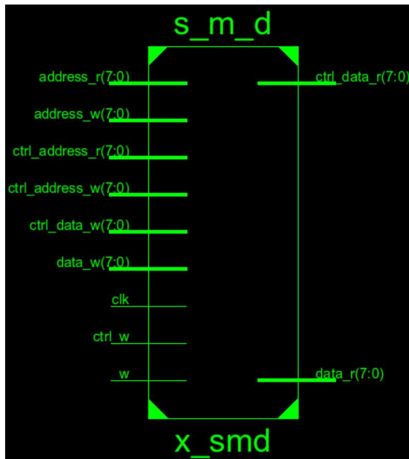
Tenter d'afficher l'ensemble des éléments contenus dans ce bloc provoque un déni de service. Il faut donc procéder morceau par morceau. Ce bloc renferme deux gros multiplexeurs de 256 entrées où chacune de ces entrées est raccordée à un circuit flip-flop. Il y a beaucoup de signaux électriques nécessaires pour le fonctionnement bas niveau, mais dont on peut faire abstraction une fois qu'on comprend le but du bloc. Un multiplexeur couplé à des circuits flip-flops sert à stocker un tableau de
